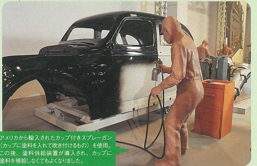
アメリカから輸入されたカップ付きスプレーガン(カップに塗料を入れて吹き付けるもの)を使用。この後、塗料供給装置が導入され、カップに塗料を補給しなくてもよくなりました。
