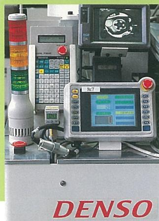
▲従来の組立ラインのイメージを一新した(株)デンソー安城製作所自動車用スター組立ライン。前へ後ろへ移動しながら、7台の移動ロボットが稼働。ロボットの数により生産量を調整できる。
