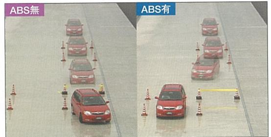
ABS実車試験(障害物の回避操作)
