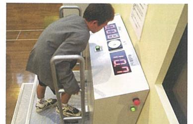
5km/hで走る軽自動車を止める時に発生する熱エネルギー(手前側表示:停止距離、奥側表示:ブレーキパッドの上昇温度)
