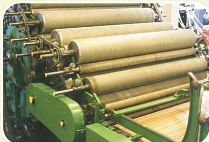
手前の竹製のコンベアに原料を乗せると、コンベアによってカードに巻き込まれていく。
