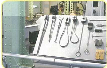
拳母工場の鉄柱と操業当時に使用されていた道具左に見える柱は、1938年に完成し、1996年の改築で撤去された拳母工場鍛造工場の鉄柱の一部を移築したもの。約10mの高さで、鍛造機や金型を吊り上げる天井走行クレーンを支えてきた。
