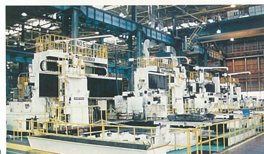
NC型彫盤(5面加工機)
