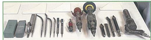
手彫りプレス型製作に用いた手作業用の工具類
