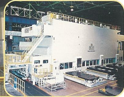
写真⑥ 5200トン大型トランスファプレス
