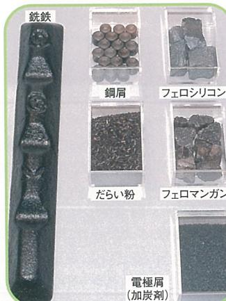
▲铸造の溶解材料の変遷
