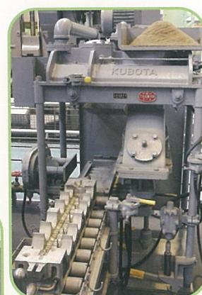
写真④ 中子は中子造型機「コアブローキングマシン」で製作。油砂をコアボックス(中子型)に空気で送り込み、油中子をつくる。中子はこの後、乾燥定盤にのせて乾燥炉で焼き固められる。
