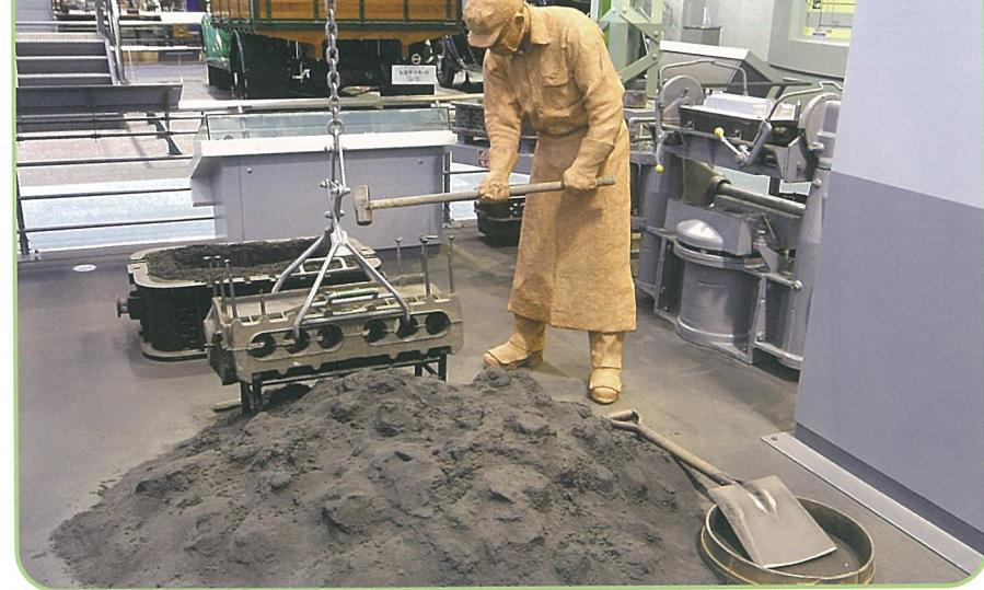
写真⑥ 製品の取り出しやバリ取りなどの後処理も手作業だった。
