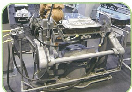
写真② アメリカ・オズボーン社製の造型機「ローラー式モールディングマシン」でシリンダーブロックの铸造型をつくった。
