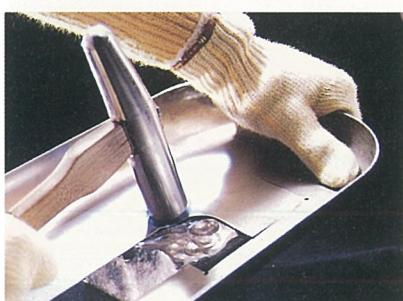
打ち出し（絞り）加工による絞る作業の様子。
