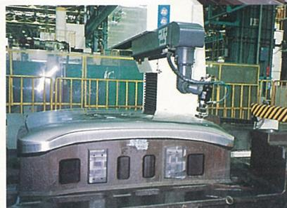
ロボットによるプレス金型研磨
