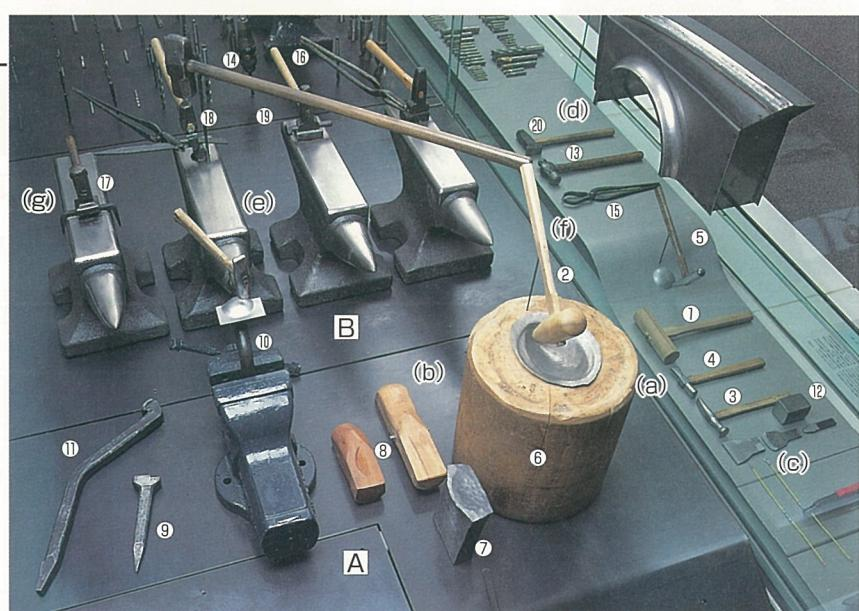
必要な形状にするために、材料に力を加えて変形させる加工を塑性加工といい、その加工には、鋼材を加熱して加工するための鍛造〔鍛冶、火造（ひづくり）〕用工具や板材を加工するための板金用工具などが用いられる。手作りで材料に力を加えるには各種のハンマ類や力を受ける台（床、盤）類が用いられ、加工する形状に応じて、曲げる、絞る（打ち出す）、延ばす（ならす、広げる、つぶす）などの変形に適した、様々な工具が用いられる。
