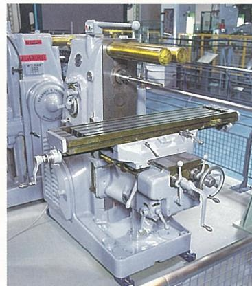
創業期に製造され、自動車部品の切削加工に活躍したトヨタ製の横型フライス盤。(自動車館 1階・生産技術)
