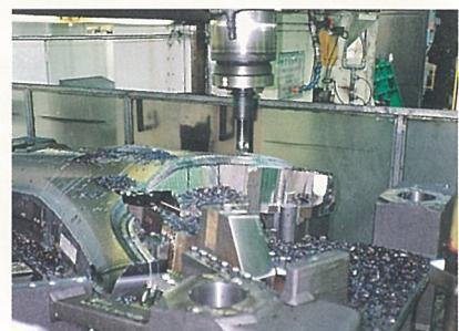
NC5面加工機による金型切削。
