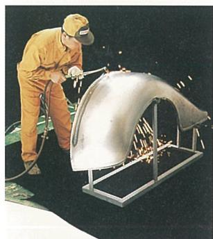
ガス溶断による切る作業の様子。
