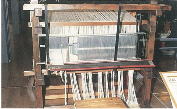
たて糸を織機に仕掛けられる状態にする準備工程の手作業による経通しの様子を展示。(織維機械館・織機コーナー)
