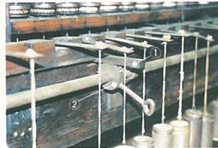
ラック (1) とビニオン (2) による天秤の支点の移動機構
